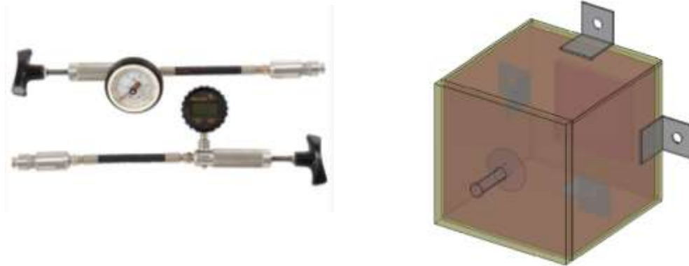
Figura 6.6 - Dispositivo per test a trazione da effettuare in situ con il metodo del pull-off
