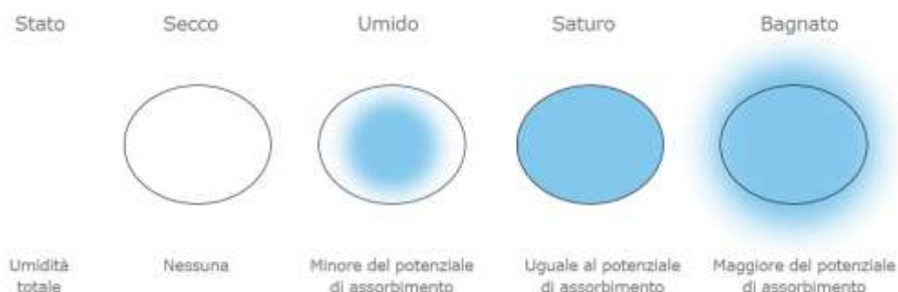
Figura 5.6 - Vari gradi di assorbimento d'acqua dell'aggregato
