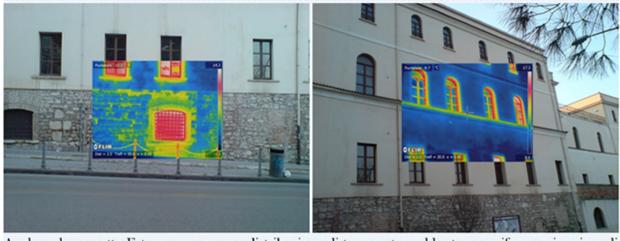
Anche sul prospetto Est emerge con una distribuzione di temperature abbastanza uniforme, sinonimo di una buona resistenza termica media della struttura.
