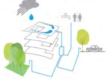
RECUPERO DELLE ACQUE PIOVANE PER IRRIGAZIONE E SANITARI.
