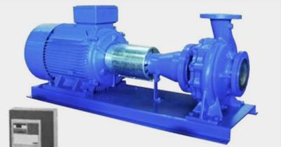
La nuova filosofia di distribuzione a portata variabile, con sotto-centrali termiche dotate di valvola di regolazione del tipo modulante a due vie, ha reso necessario l'installazione di una stazione di pompaggio regolabile in funzione delle richieste termiche delle varie sottocentrali.
