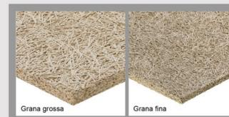
Le pareti interne e il soffitto della palestra sono rivestite con dei pannelli in fibra di legno mineralizzata: si tratta di pannelli dalla doppia funzione di isolamento acustico e termico, resistenti agli urti e agli impatti dinamici. Sono inoltre resistenti al fuoco, all'acqua e inattaccabili dall'umidità.
